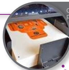
Przednie impulsy powietrzne i separatory wspomagają rozdzielanie nośników, aby idealnie podawać każdy arkusz.
